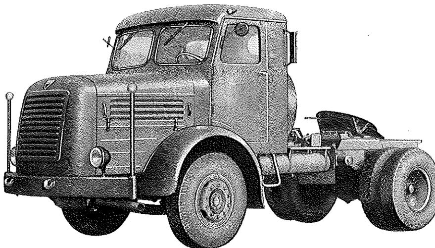
**Diesel-Motor · 8 Zylinder · 4-Takt · 170 PS bei 2300 U/min**
